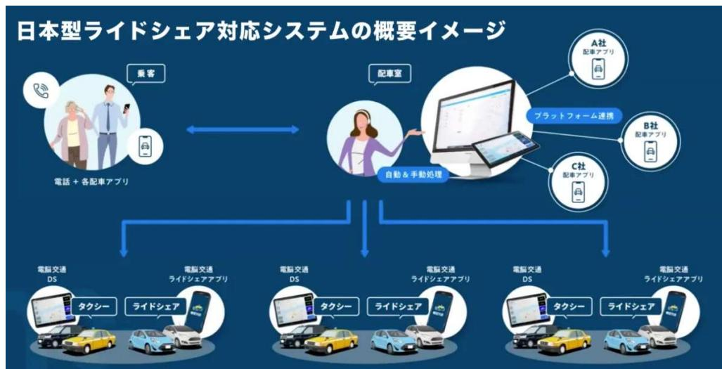
乗客は電話注文・配車アプリ注文のどちらも利用でき、タクシーと日本型ライドシェアのどちらの車両も選択可能です。またタクシー事業者側でもタクシーと日本型ライドシェア車両を1つのシステムで運行管理が可能であり、従来のドライバー用タブレット端末だけでなくライドシェア車両向けのスマートフォン版ドライバーアプリを提供します。日本型ライドシェアの運行に必要な事前確定運賃、キャッシュレス決済などにも対応します。
